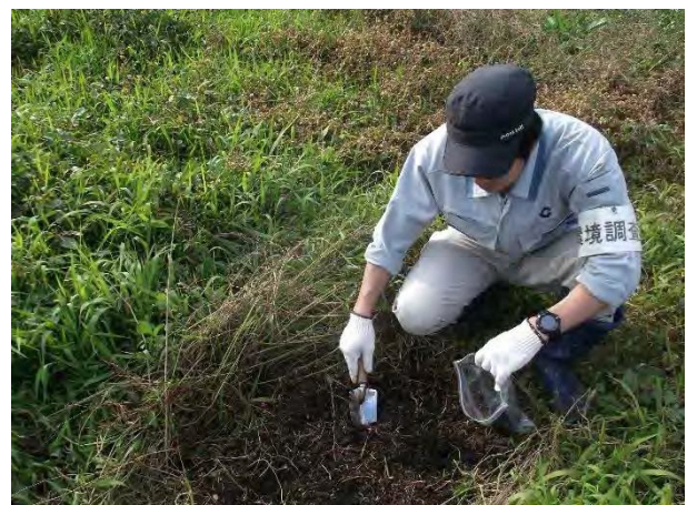
土壌沈降試験用の土採取状況
