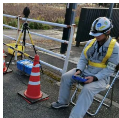
道路交通振動調査の状況
